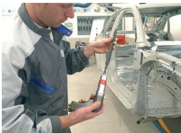
En el caso de brocas BTR/BOR para el despunteo en aceros de ultra-alta resistencia (UHSS) el útil debe posicionarse sobre el punto a despuntear formando un ángulo de 90°, y una tolerancia máxima de +/-10°, respecto a la superficie de la chapa para evitar el riesgo de rotura de la broca. La presión de funcionamiento de la despunteadora debe ser entre 6-8 bares / 90-120psi y la presión de apriete sobre el punto no debe sobrepasar los 3kg.
