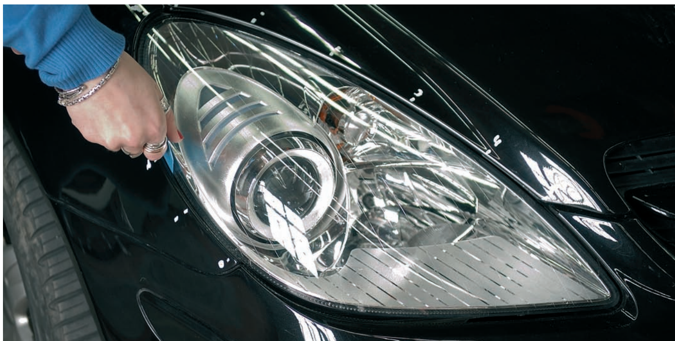
Verificación de holguras y enrasas en un dispositivo delantero
