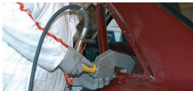
Finalmente es importante destacar que para poder utilizar este equipo es necesario tener acceso por ambos lados de la unión.
