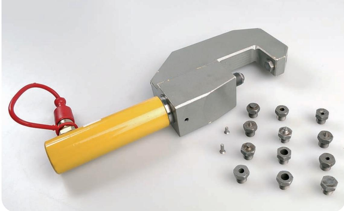
Las piezas unidas en fabricación por remaches estampados pueden ser extraídas con este equipo sin dañar la pieza interior y además también permite ensamblar el recambio nuevo a la carrocería con remaches macizos de aluminio.
