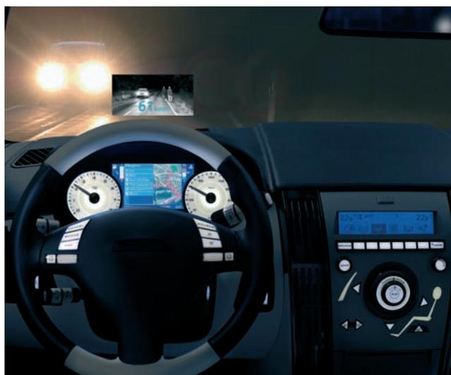
El sistema de Visión Nocturna muestra la situación de la carretera en una pantalla integrada en el tablero de instrumentos en tiempo real.
