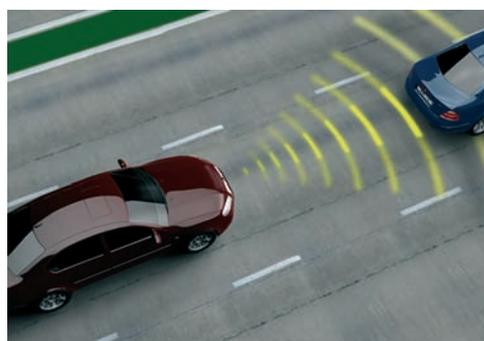
El Control de Velocidad de Crucero Adaptativo controla de manera automática la distancia de seguridad entre nuestro vehículo y el que nos precede.
