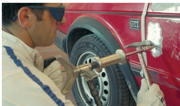
Dispositivos con doble función: soldar y traccionar.
