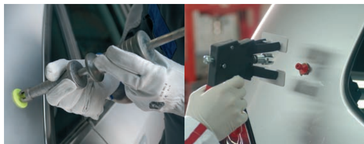
Tracción desde el exterior con útiles pegados a la superficie
