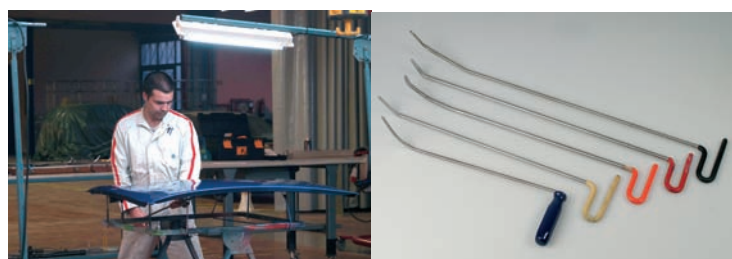
Las pequeñas abolladuras por granizo pueden extraerse sin estropear la pintura mediante varillas de acero con diferentes formas en la punta.
