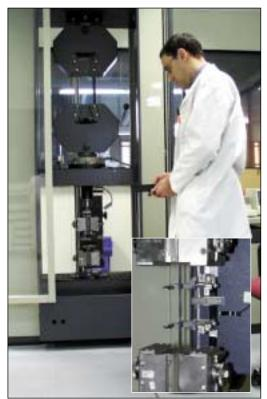
Para ampliar la información acerca del acero utilizado, y catalogarlo de manera más ajustada, se somete a una serie de probetas extraídas de la propia pieza a un esfuerzo de tracción hasta su rotura, tal y como se describe en la norma EN 10002-1 "Materiales metálicos. Ensayo de tracción. Parte 1: Método de ensayo (a la temperatura ambiente)". De esta forma se determinan propiedades mecánicas del material tan importantes como su límite elástico, alargamiento al 80% o la carga de rotura.
