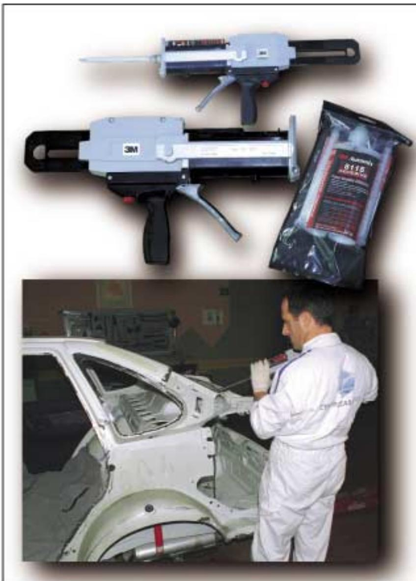
El adhesivo para pegado de paneles 08115 es un adhesivo epoxi bicomponente diseñado para pegar acero o aluminio, cuya utilización va destinada a reemplazar parcialmente la soldadura en operaciones de sustitución de paneles de carrocería como aletas posteriores y techos. No está diseñado para ser utilizado en la unión de elementos estructurales de la carrocería del vehículo.
