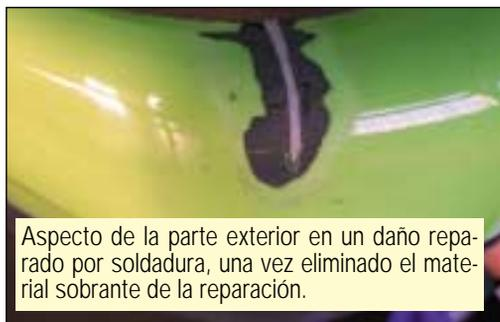
Aspecto de la parte exterior en un daño reparado por soldadura, una vez eliminado el material sobrante de la reparación.
