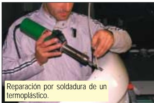
Reparación por soldadura de un termoplástico.
