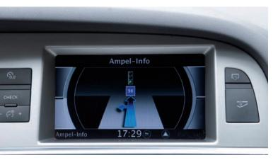
El sistema se aplicó a 46 semáforos del área metropolitana de Ingoldstadt (Alemania). El software instalado en estos dispositivos optimiza el funcionamiento de la red de semáforos, reduciendo significativamente la duración de las paradas de los vehículos. Los semáforos, comunican a la unidad de mando del coche el tiempo restante hasta que éstos estén en verde y así se les permita circular.
