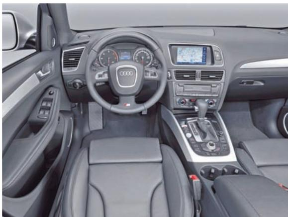
miento. El conductor puede dejar que el S-Tronic gestione los cambios de modo completamente automático o hacerlo él mismo de forma manual opcionalmente, mediante levas de cambio en el volante.
