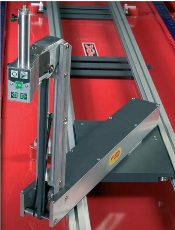
Brazo palpador electrónico del Speed System.
