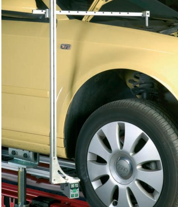
Útil para la medición del McPherson.
