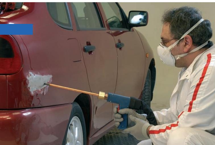
*Para eliminar los estiramientos de la chapa se utiliza el método térmico basado en el calentamiento y enfriamiento de la superficie.*
