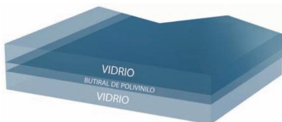
*Estructura de un vidrio laminado.*
