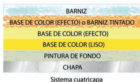
**BASE DE COLOR:** En sistema bicapa, base con pigmentos lisos, metalizados o perlados, o mezclas de ellos.
