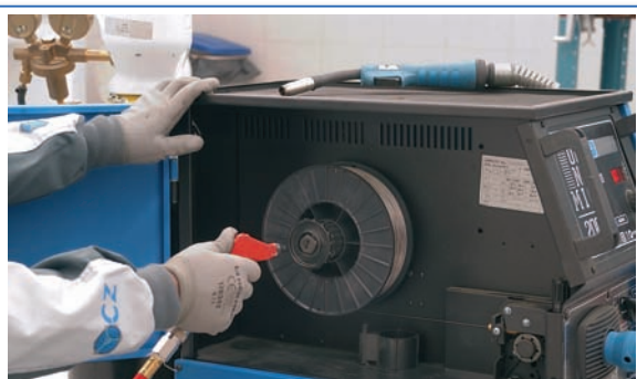
1 Soplado del polvo en el interior del equipo.
