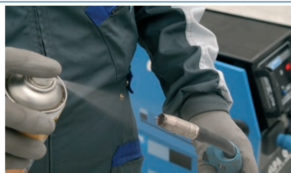
8 Aplicar spray en toberas para evitar adherencia de proyecciones.
