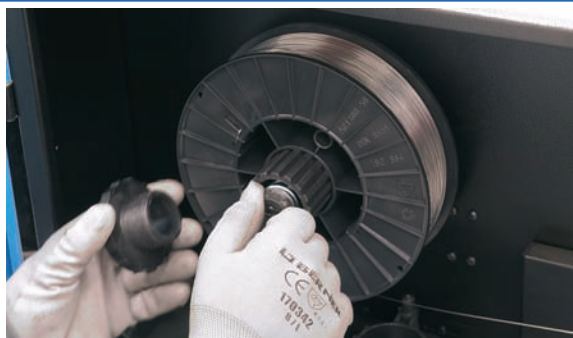
5 Ajuste del freno para evitar inercia en la bobina.
