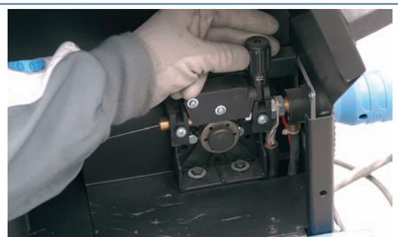
4 Ajuste de presión de roldanas de tracción.
