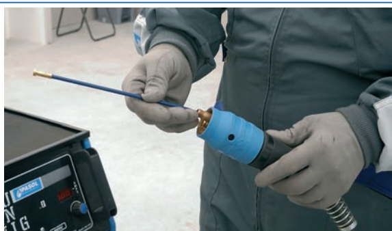
7 Verificar estado de la manguera y limpieza del tubo guía de alambre.
