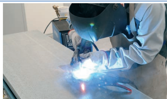
10 Realización de soldadura en probetas para comprobar parámetros.
