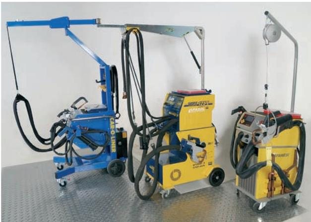
*Equipos de soldadura por resistencia eléctrica por puntos.*
