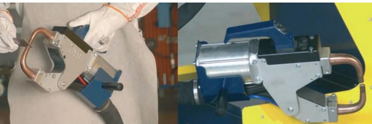
*La soldadura de aceros de ultra-alta resistencia necesita mayores amperajes y fuerzas de presión de la pinza.*
