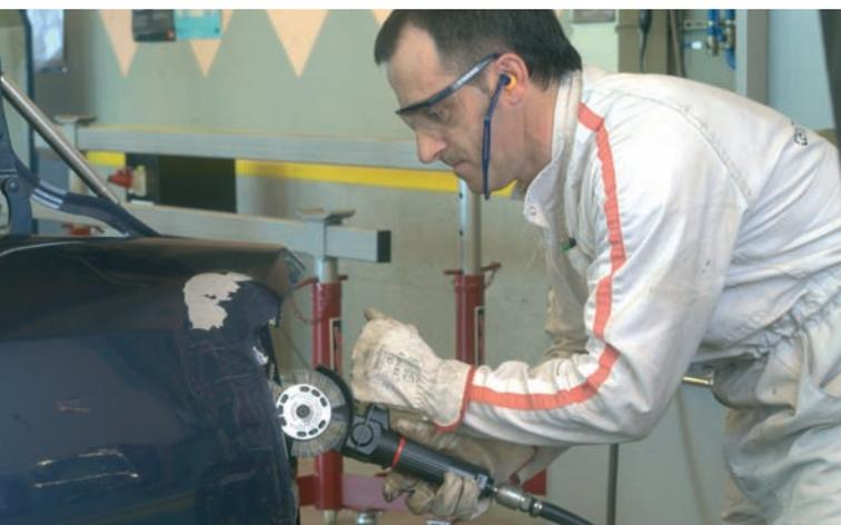
*La soldadura de aceros de ultra-alta resistencia requiere eliminar previamente el revestimiento de aluminio de la chapa.*
