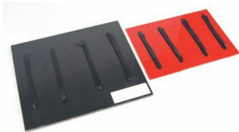
Probetas de vidrio serigrafiado y chapa pintada para la evaluación de la resistencia al pelado.
