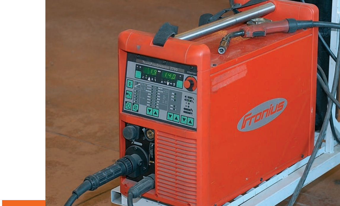
Equipo de soldadura por arco eléctrico MIG, sinérgica y con arco pulsado.
