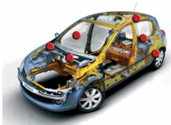
En CENTRO ZARAGOZA se han realizado varias pruebas en diferentes puntos de la carrocería de un vehículo para verificar las posibilidades de trabajo de la lijadora SPANESI SP711702 (ver Figura 1). Se destaca la gran facilidad y agilidad de uso por su diseño y reducido tamaño, el buen trabajo que realiza en zonas inaccesibles para otras herramientas (pequeños rincones, huecos, pestañas estrechas...) y la posibilidad de mecanizar superficies reducidas. 🟢
