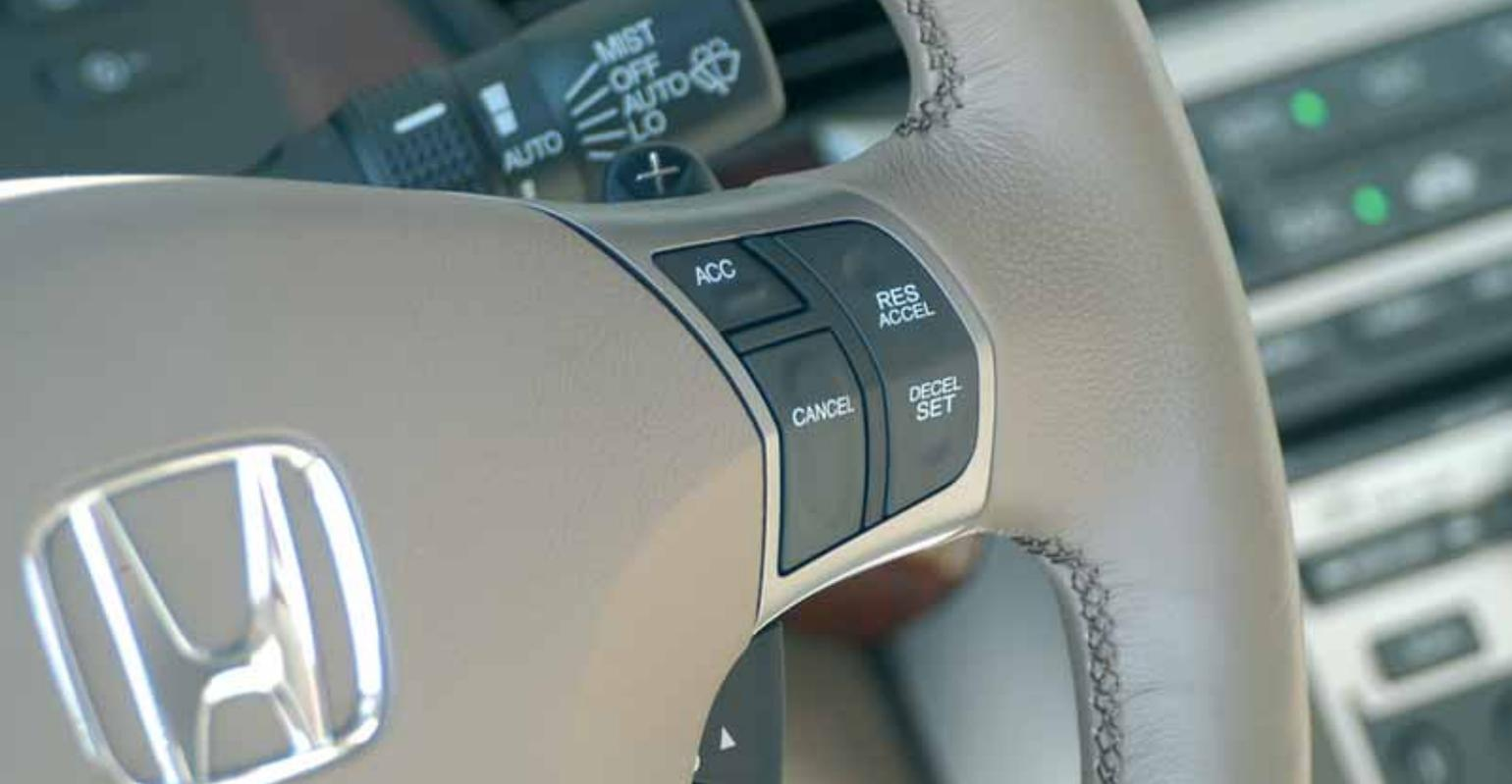
*El sistema ACC es un sistema que permite mantener una distancia de seguridad determinada con el vehículo precedente.*
