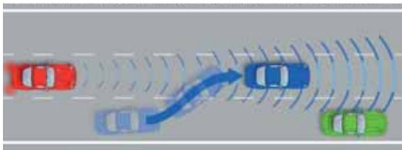
*Al cambiar de carril, éste queda de nuevo libre: El ACC acelera el vehículo hasta alcanzar de nuevo la velocidad prefijada*
