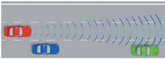
*Aparece un vehículo interponiéndose por delante: El ACC frena el vehículo para mantenerlo a la distancia de seguridad prefijada*
