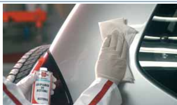
2 Limpieza de la zona de trabajo.
