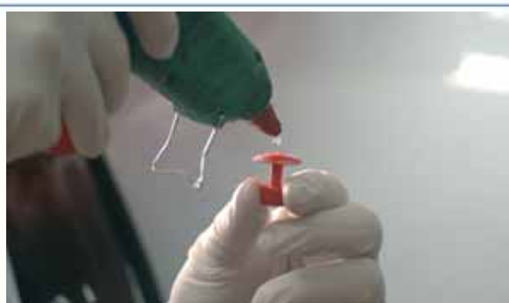
3 Aplicar adhesivo sobre la ventosa o base.
