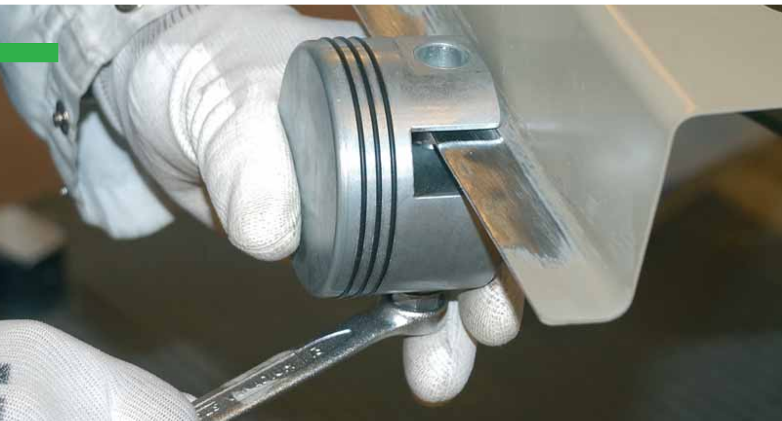
Colocación y fijación de la sufridera
