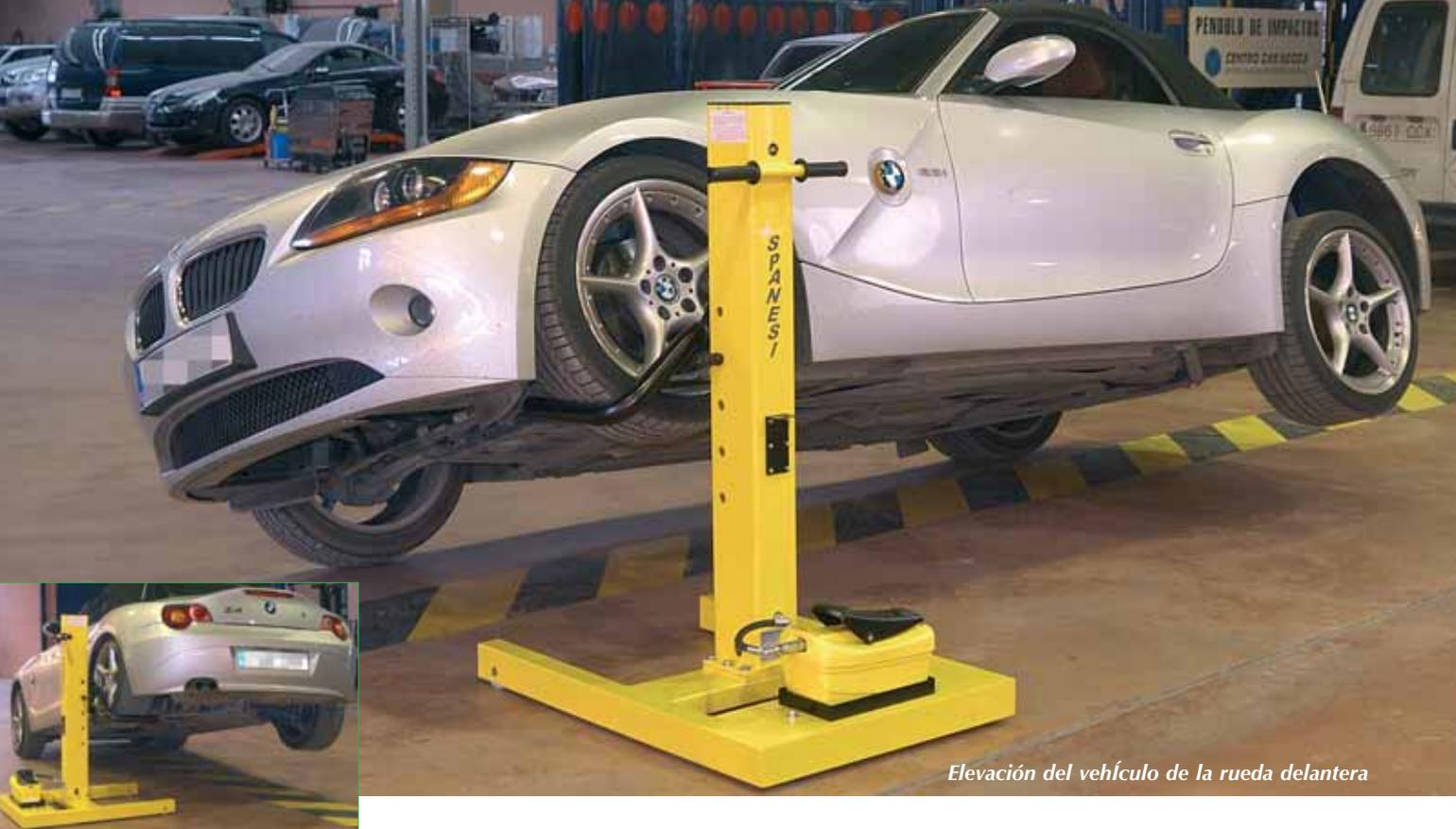
*Elevación del vehículo de la rueda delantera*
