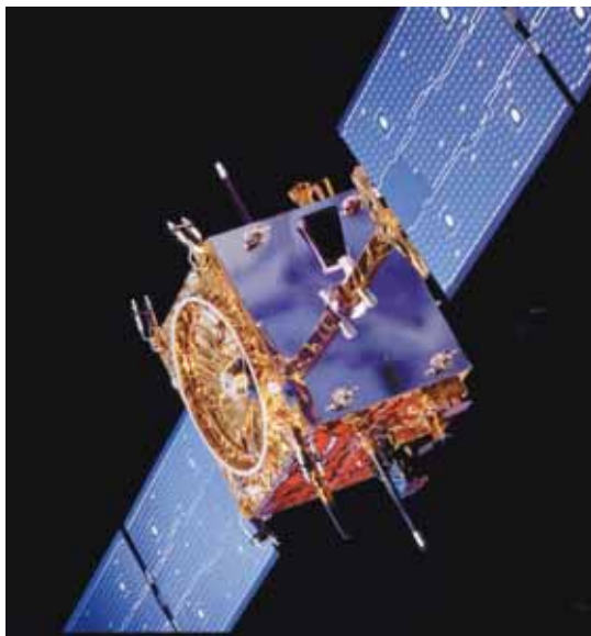
Satelite SMART-1 con células solares de Ga y As
