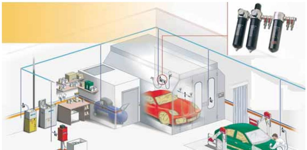
Instalación de aire a presión. Imagen cedida por Aerometal
