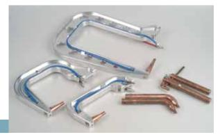
La soldadura de resistencia eléctrica por puntos es el tipo de soldadura más recomendado por los fabricantes para el ensamblaje, en reparación, de las diferentes piezas de la carrocería.
