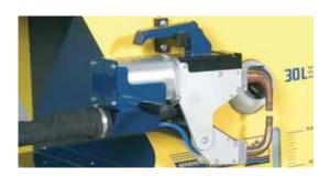
En CENTRO ZARAGOZA se han obtenido resultados muy satisfactorios respecto a la utilización de la soldadura Gyspot Inverter 125L integral, destacando por la posibilidad de la utilización de una pinza en "C" o una en "X" indistintamente, y por la sencillez de manejo gracias a los programas de soldadura de que dispone, con los que permite soldar distintos tipos de acero, destacando también al permitir variar el espesor de las chapas a soldar desde la propia pinza de soldadura.
