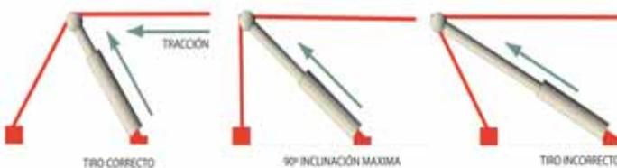
Para la instalación de los elementos de estiraje, en primer lugar, se debe elegir la dirección de tiro que tiene que coincidir con el lado de la cadena anclada a la carrocería. Esta dirección elegida se asegura con la elección del cilindro adecuado, en cuanto a su longitud y a su anclaje. A continuación se introduce presión en el cilindro y se observará si una vez tensada la cadena, mantiene la dirección elegida inicialmente.
