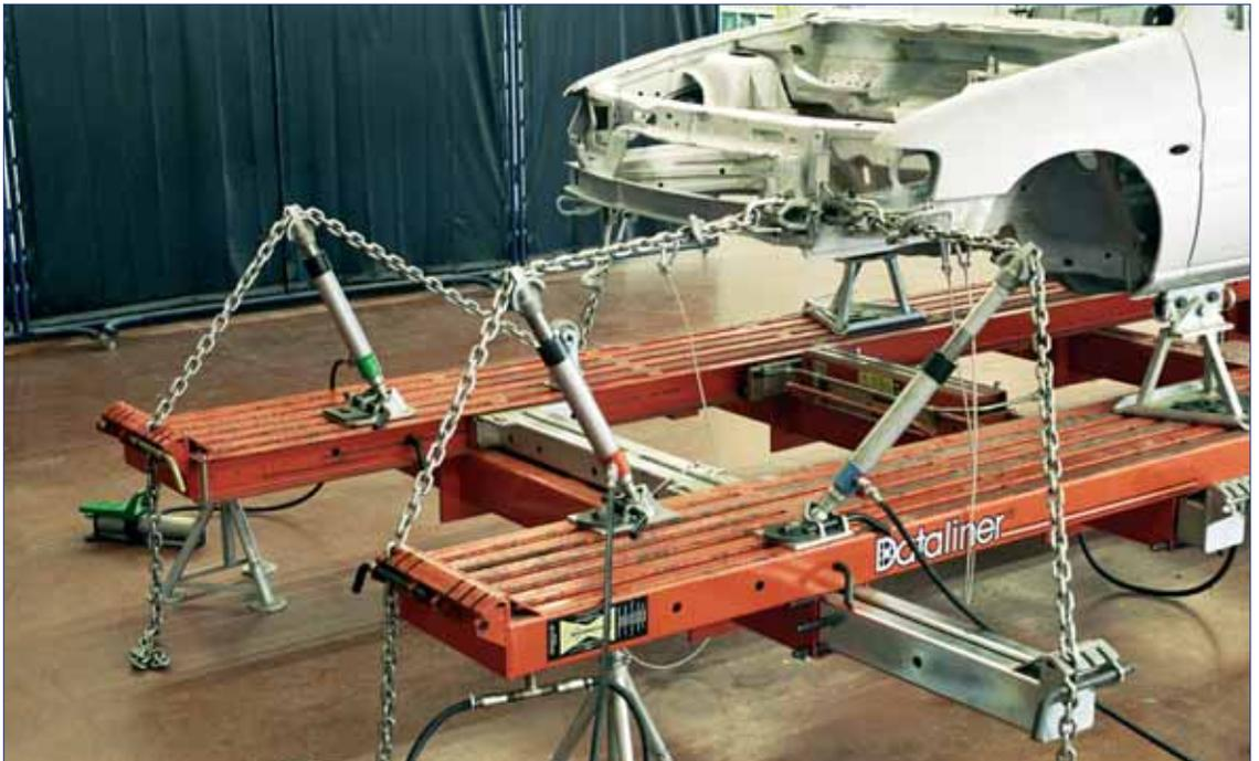
**E**l diseño de las carrocerías actuales es complejo, basándose en criterios de deformabilidad de su estructura en caso de impacto para aumentar la seguridad de los ocupantes del vehículo. En función de la magnitud de éste, se deformarán más o menos las piezas y si éstas no recuperan sus dimensiones y cotas originales, el funcionamiento mecánico y la seguridad del vehículo pueden verse gravemente afectadas.
