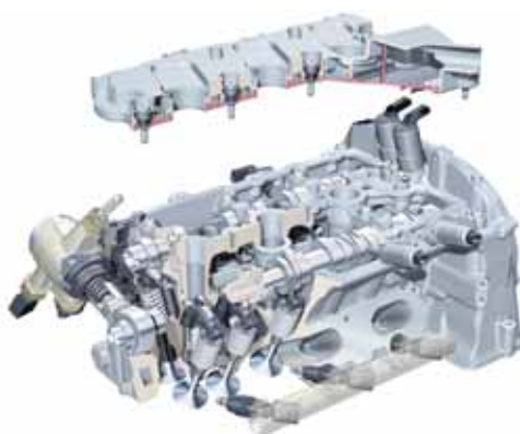
Detalle de Culata del sistema Valvelift de Audi
