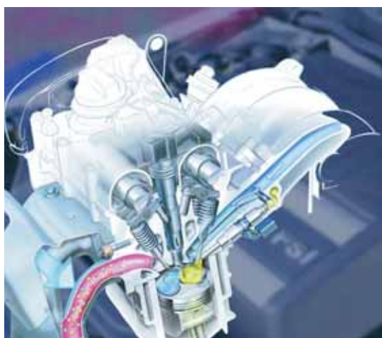
Detalle de la motorización FSI de Volkswagen
