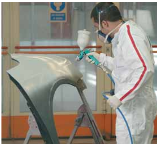
Aplicación de epoxi al agua
