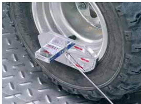
La alineación correcta se observa comprobando que en cada lado nos de la misma medida en los indicadores delantero y trasero colocados en la ruedas delanteras. Si no es así se debe ajustar hasta que ocurra esto, aunque siempre siguiendo las indicaciones del fabricante del quad.
