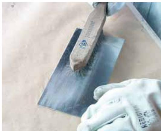
*Eliminación de la alúmina en una pieza de aluminio mediante un cepillo con púas de acero inoxidable.*
