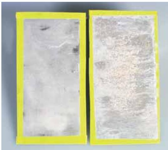
Ensayo de oxidación en dos probetas de aluminio, la de la izquierda es la chapa sin más, mientras que la de la derecha lleva proyecciones de partículas de acero, en ésta se puede observar la oxidación del aluminio por contacto con el acero.
