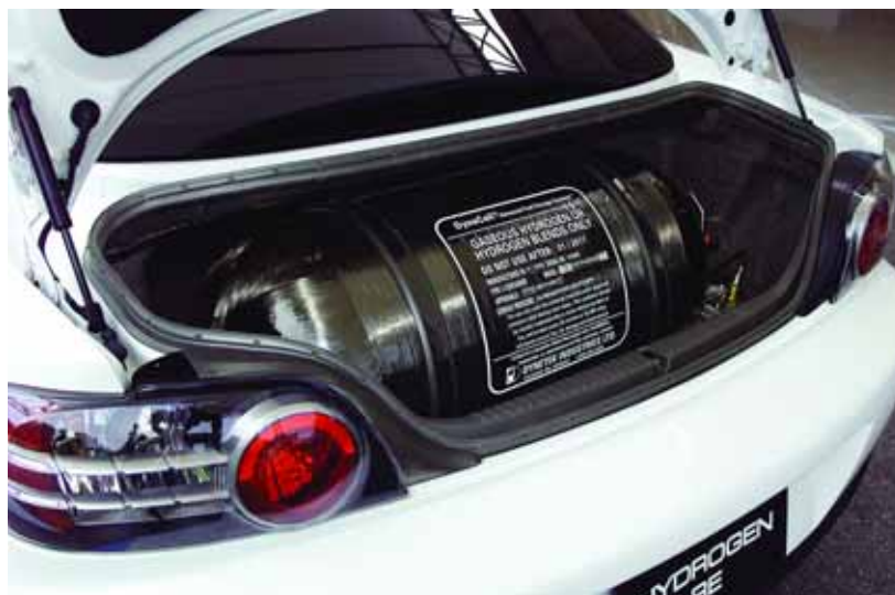
Detalle de un depósito de hidrógeno
