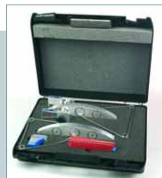
Una operación que se debe realizar periódicamente en la motocicleta es el tensado de la cadena de transmisión, durante el mismo se puede variar la alineación de las ruedas de la motocicleta. Así mismo, es muy importante que después de un siniestro, se compruebe la correcta alineación de las ruedas de la motocicleta.
