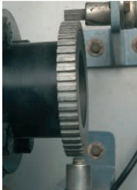
tanciamiento calibrado para no rozar con el sensor. A la separación específica entre el sensor y la corona se le denota como entrehierro. Con el aumento de esta distancia se produce una disminución de la tensión generada por el sensor y por el contrario con un acercamiento se produce un aumento, en esta última situación se pueden producir rozamientos del sensor con la corona.
