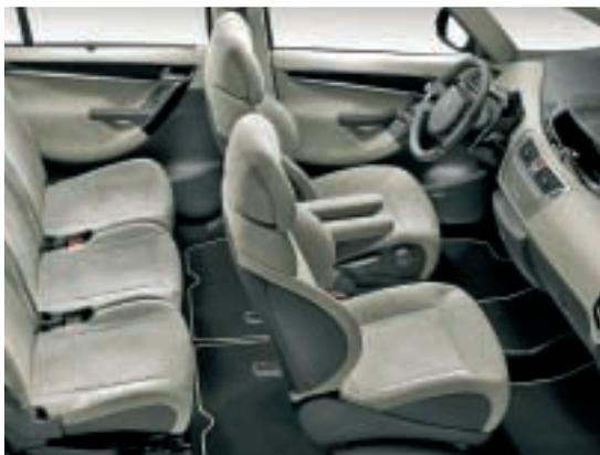
Citroën ha eliminado todo posible obstáculo entre el asiento del conductor y pasajero, por eso la palanca de cambios se encuentra situada en la columna de la dirección y el freno de mano eléctrico se encuentra en la parte inferior del cuadro de instrumentos.
