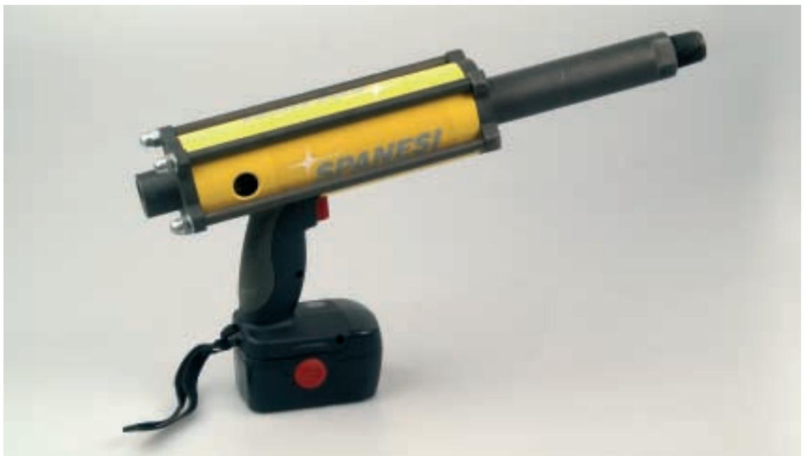
*La continua evolución en el mundo de la reparación de carrocerías de automóviles da lugar a la aparición de nuevos equipos, que facilitan el trabajo al reparador. El ELECTRO PULLER de Spanesi es un gato eléctrico de tiro y empuje, que facilita los trabajos de estiraje de la carrocería en las bancadas, eliminando las molestias e inconvenientes de los latiguillos y mangueras de aire de los clásicos sistemas de gatos hidráulicos de accionamiento manual o neumático.*
