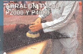
Las lijas ABRALON P1500, P2000 y P4000 por su mínimo poder de arranque son las que se emplean para la eliminación de defectos superficiales en la pintura, con la particularidad de que una vez eliminados dichos defectos no es preciso el repintado de las piezas, sino que un proceso de pulido a abrillantado devolverá a la pintura su aspecto inicial, con la garantía de que tras el abrillantado no quedará visible marca alguna de lijado.■
