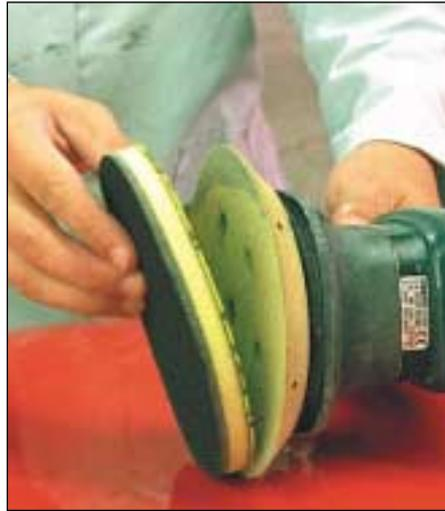
un lado y fibra por el otro), pueden intercalarse entre el plato de la lijadora y la lija ABRALON.
