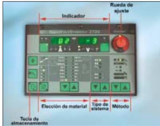
ciales señalados por el equipo, el usuario puede realizar los ajustes de los parámetros de soldadura en la forma deseada.
