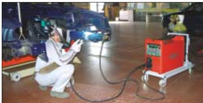
Para la opción de arco pulsado en soldadura MIG, hay una forma de impulso adecuado a cada tipo de material. La precisión del equipo hace que solamente se desprenda una gota de material de aporte con cada impulso de corriente, lo que da lugar a una buena transferencia del material y un nivel de salpicaduras mínimo.
