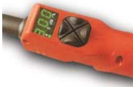
Para trabajar de forma más cómoda se puede utilizar el Job Master, una antorcha con mando a distancia incorporado, desde la cual se puede ajustar los parámetros como potencia, velocidad de hilo o longitud de arco durante el proceso mismo de la soldadura.
