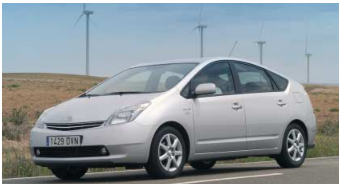
LA VERSIÓN ACTUAL DEL HÍBRIDO JAPONÉS SIGUE BASANDO SU FUNCIONALIDAD EN UNA MOTORIZACIÓN BASADA EN EL CICLO ATKINSON Y EN OTRA ELÉCTRICA.
