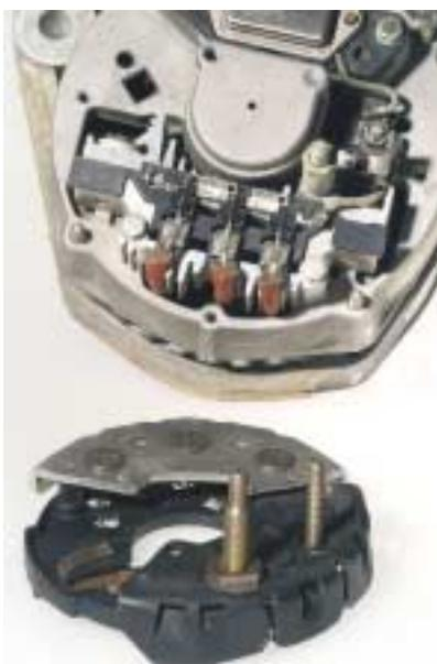
PUENTE DE DIODOS Y ALTERNADOR
