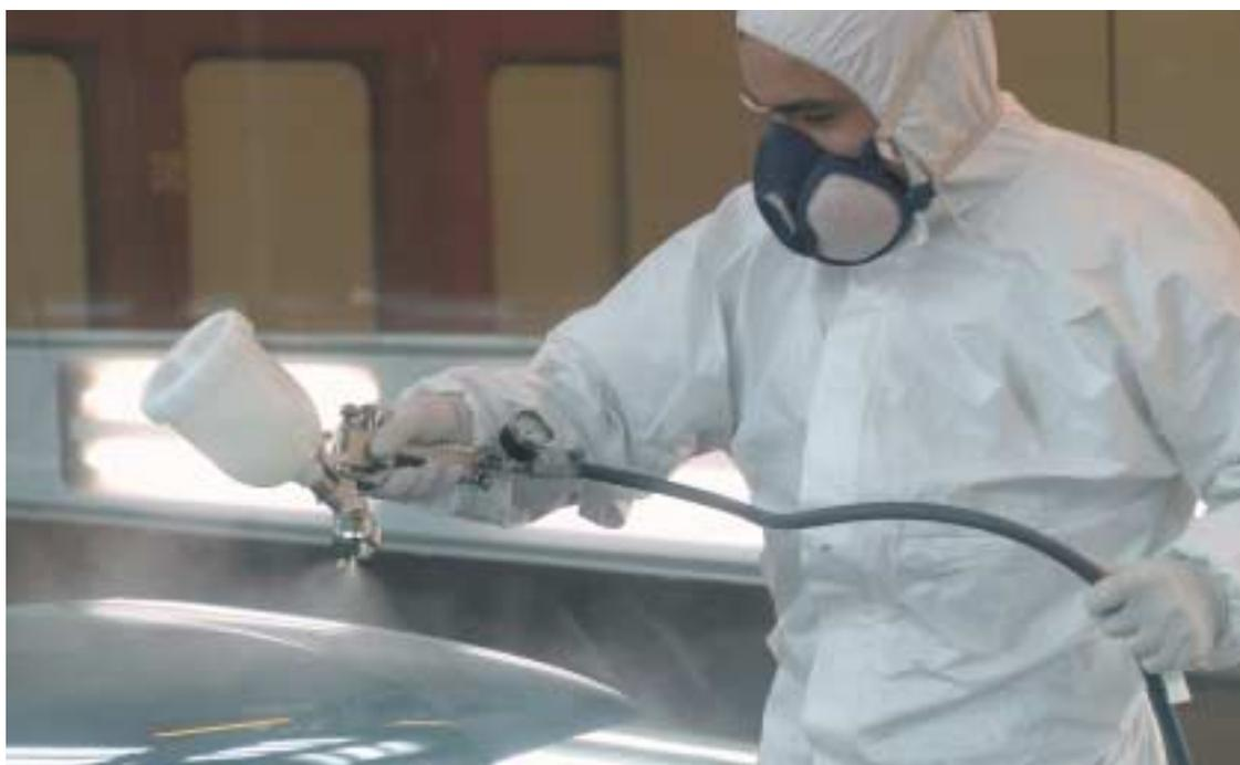
el ángulo que forman los paneles, de por sí ya genera una distinta percepción del efecto metalizado o perlado, con lo que las desviaciones de color debidas a la aplicación son suficientemente enmascaradas por este efecto.
