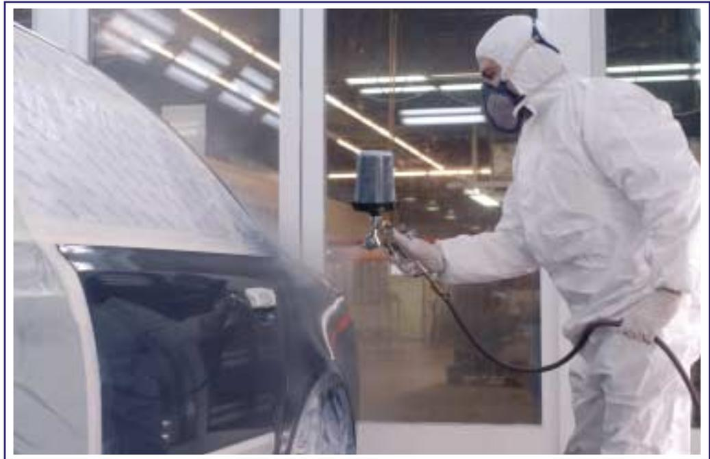
*Difuminado, parche, parche perdido, spot-repair, reparación SMART, etc... son términos que se utilizan en pintura de reparación para designar una técnica de pintado que permite mejorar la igualación de color del acabado aplicado con el color preexistente en el vehículo.*
