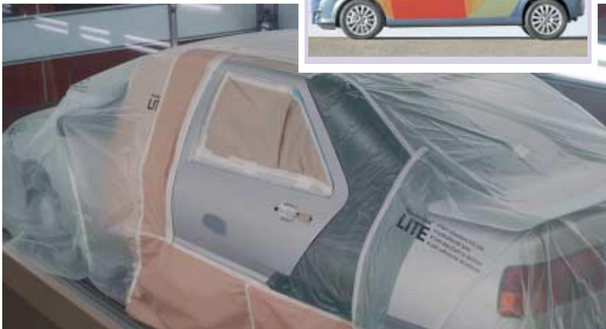
parámetros de aplicación (distancia de la pistola a la pieza, presión de aplicación, velocidad de barrido, etc.) la orientación de los pigmentos metalizados y perlados es diferente, lo cual repercute en el efecto de color y brillo final.
