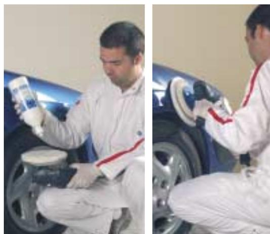
mas, obteniendo un acabado muy brillante. Además, tanto la esponja como la lana, mantienen la superficie fría para evitar que reaparezcan huellas de lijado.
