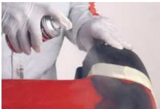
APLICACIÓN DE LA IMPRIMACIÓN DE ANCLAJE
