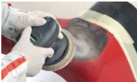
LIJADO FINAL POR LA CARA EXTERIOR
