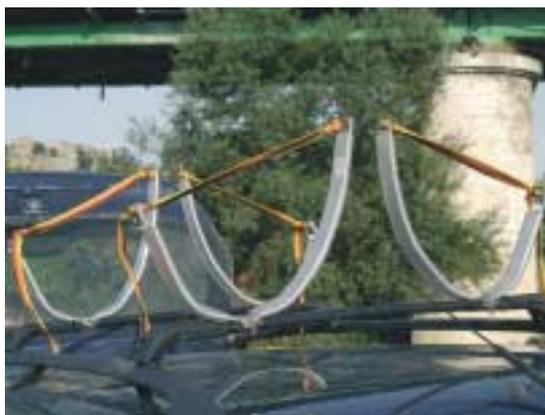
*EXISTEN ACCESORIOS QUE NOS PERMITEN TRANSPORTAR MÁS DE UNA PIRAGUA SOBRE EL TECHO DEL VEHÍCULO.*
