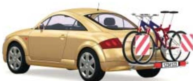
*LA PARTE QUE SOBRESALE NO PODRÁ SUPERAR EL 15% DE LA LONGITUD DEL VEHÍCULO, Y DEBERÁ SER SEÑALIZADA CON LOS CORRESPONDIENTES PANELES (V-20).*
