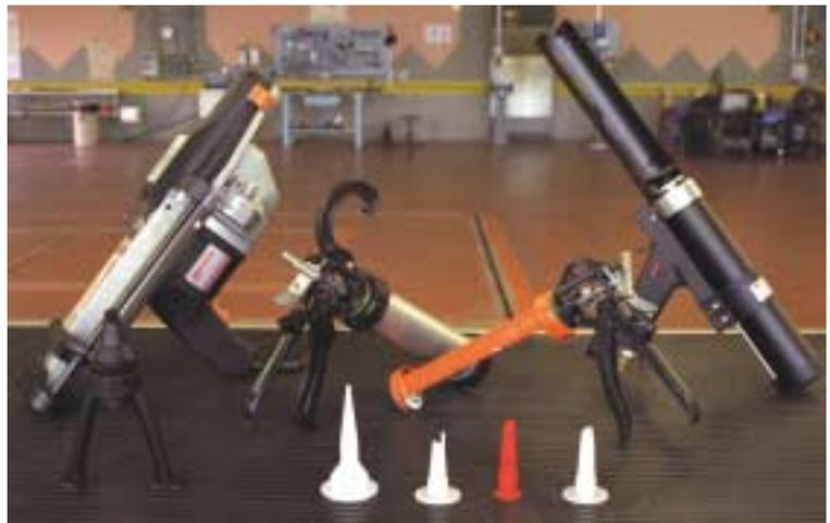
*PISTOLAS Y BOQUILLAS UTILIZADAS PARA LA APLICACIÓN DEL ADHESIVO.*
