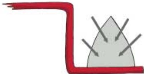
*LOS POLIURETANOS BICOMPONENTES POLIMERIZAN EN TODAS LAS DIRECCIONES DEL CORDÓN, AL MEZCLARSE LOS DOS COMPONENTES.*
