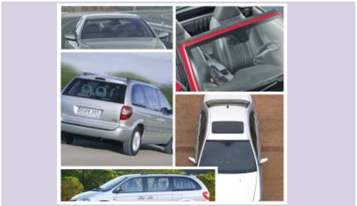
Los primeros parabrisas se unían a la carrocería mediante fijaciones mecánicas, después se utilizaron los junquillos de goma. Los inconvenientes que presentaban este tipo de uniones, montajes caros y la necesidad de un sellado adicional, dio lugar a que se utilizase la unión por adhesivos, entre los cuales se instauró y sigue manteniéndose el poliuretano, gracias a las características mecánicas que posee.
