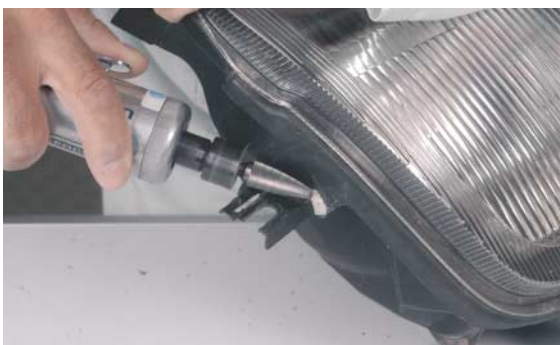
9 Acabado. Una vez enfriada la zona trabajada, se retira solamente el material necesario para que el faro pueda montarse correctamente en el vehículo.
