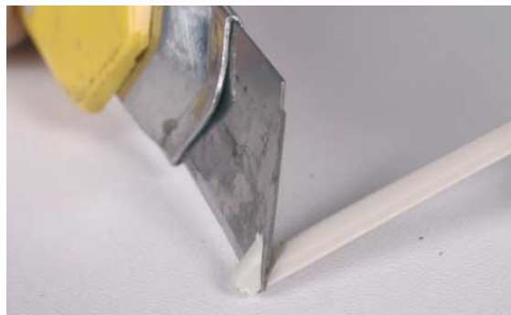
6 Preparación de la varilla cortando el extremo en forma de cuña.
