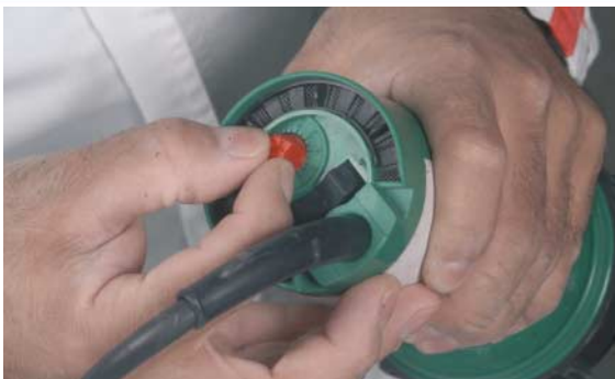
5 Regulación del soplete a la temperatura adecuada del plástico.
