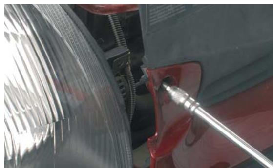
10 Montaje. La reparación termina con el montaje del faro comprobando que éste se acopla perfectamente al vehículo
