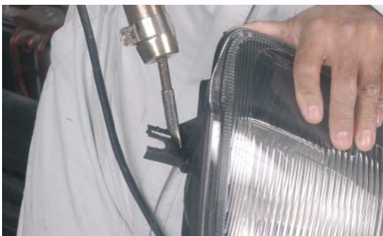
7 Punteado de las superficies a unir, sin aportar material, y utilizando la boquilla de cuña.
