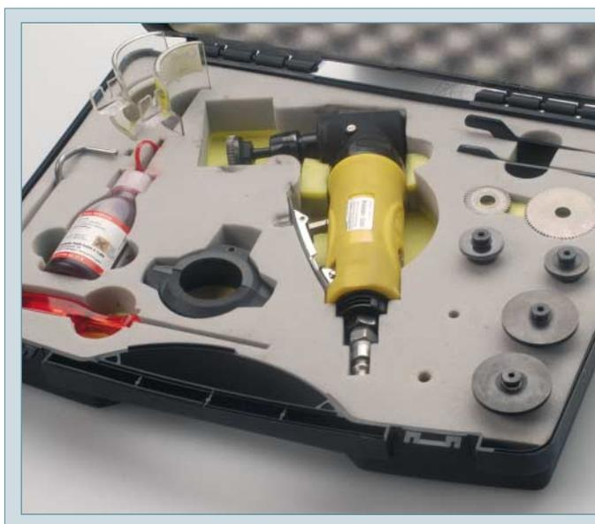
Una técnica de unión utilizada por algunos fabricantes de automóviles es la soldadura por puntos láser. Para la eliminación de este tipo de unión, hasta ahora se realizaba con una esmeril de disco, ya que no sirven los clásicas fresas despunteadoras utilizadas para los puntos de soldadura por resistencia. Sin embargo, actualmente se dispone de un equipo adecuado y diseñado para facilitar la eliminación de estos puntos láser, como es el LÁSER CUTTER LC04.
