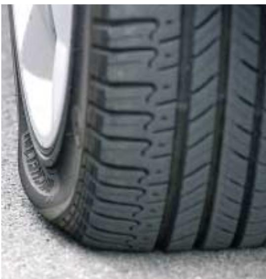
receptor, colocado en el chasis del vehículo, que procesa la información y la transmite al salpicadero, avisando al conductor de que uno de los neumáticos rueda sobre el soporte. Además, si en estas circunstancias se supera la velocidad de 80 Kms por hora, suena una señal sonora continua.
