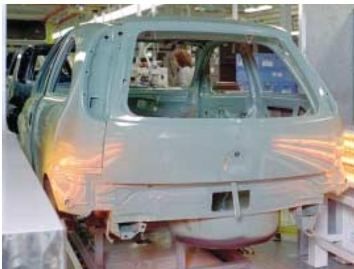
El acero es el material por excelencia utilizado para la construcción de las carrocerías de los automóviles. Pero bajo la denominación de acero se encuentran diferentes calidades con características muy particulares que propician la utilización de una u otra según la aplicación concreta.
