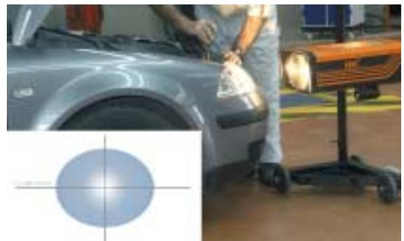
**8** Comprobar que el haz de luz de carretera coincide con el centro de las líneas del regloscopio
