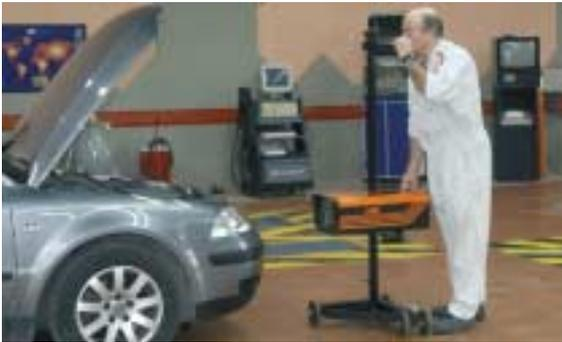
**5** Alinear el regloscopio paralelamente al eje longitudinal del vehículo.
